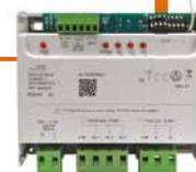
Il ricetrasmittitore **RTX01FC** può essere abbinato al termostato umidostato TEUM01 per controllare l'azione di un fancoil, gestendo l'apertura della valvola e le velocità della ventola.
