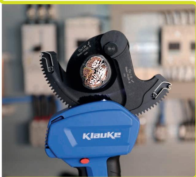
**Elevata forza elettromeccanica di taglio** per il taglio di cavi in rame e alluminio o di linee aeree e cavi armati
