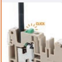
Il conduttore viene inserito nel punto di contatto con un clic chiaramente udibile. Il punto di contatto attivato è segnalato visivamente anche da un aumento dell'altezza dello spintore.
